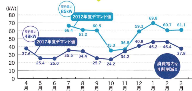
三幸駿河台ビルにおける月次デマンド(最大需要電力)値の変化
